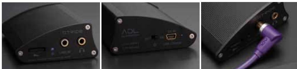
**左圖** 右面板為常用功能操作區，配置了音量控制、Line in以及Phone out端子。**中圖** 左面板的配置較為簡單，除了電源開關之外，就只有USB的端子，具備了充電與連接電腦的功能。**右圖** 原廠加贈的ADL iD-35L訊號線（前五十名購買者才有），長度為15公分，是針對隨身訊源而規劃的版本。
