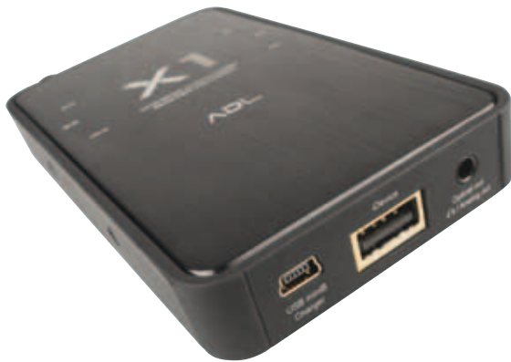
iDevices werden per USB angeschlossen und digital ausgelesen, per Mini-USB wird geladen oder die USB-DAC-Funktion genutzt
