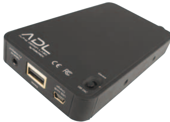
Per Schalter wählt man den regulären Mobilbetrieb an einem iPhone oder iPod beziehungsweise den Desktopbetrieb am Computer aus
