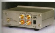
ライン入力はスイッチによりLINE、MM、MCの切り換えが可能。多彩な機器との接続に対応する
