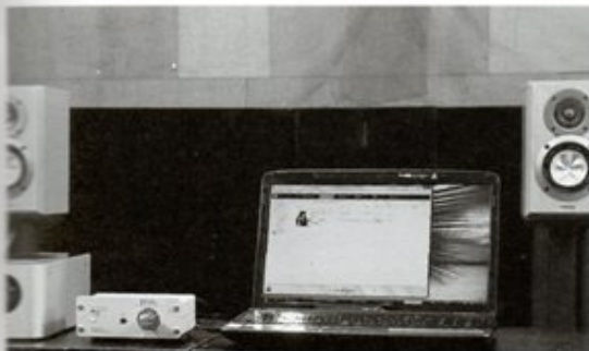
今回はパソコンとGT40 USB DACを接続し、GT40 USB DACのライン出力をマランツM-CR603へ送り出して聴いてみた
