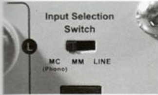
背面には入力端子の入力感度切り替えスイッチがあり、ラインレベル、フォノMM、フォノMCに対応する。感度はそれぞれ1V、5mV、0.5mV
